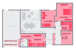
Le panneau de contrôle ne peut pas être implanté dans les emplacements en rose sur le dessin.
