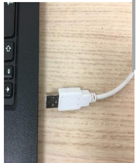
Raccordement du modem à une prise USB du PC
