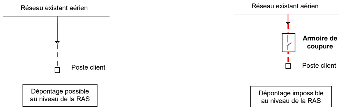
Figure 17 - Exemples de moyens de séparation d'un poste de livraison sur un réseau aérien
