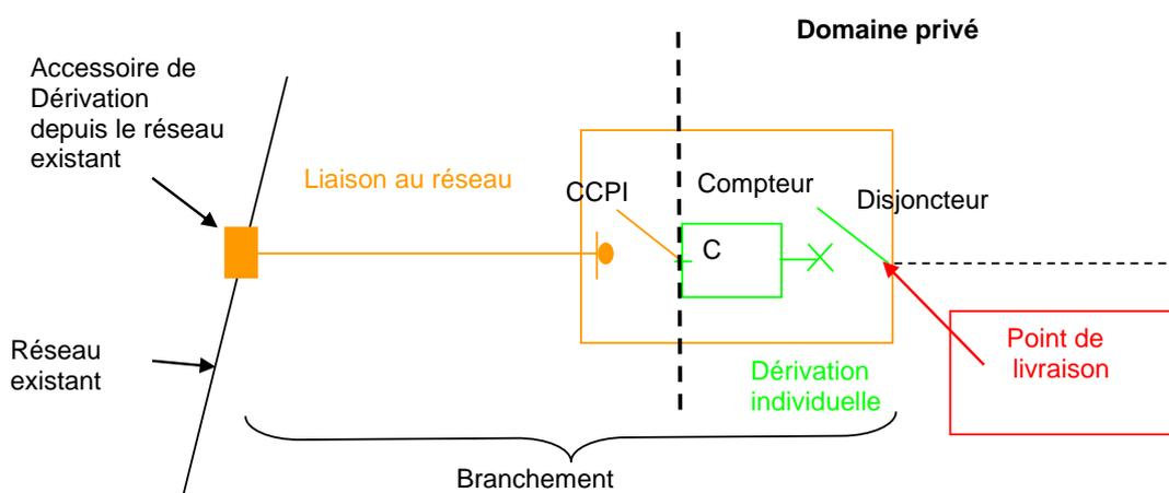
La liaison en partie privée en aval du point de livraison est entièrement réalisée par le demandeur; elle ne fait pas partie des ouvrages concédés à Enedis et doit être conforme à la norme NF C 15-100.
