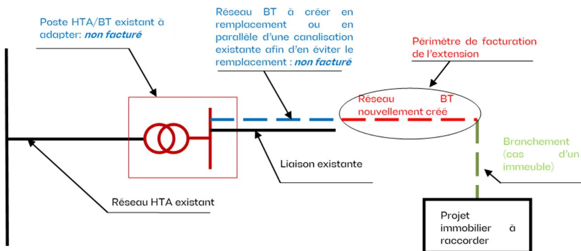
Lorsque l'opération de raccordement de référence consiste à créer un nouveau poste HTA/BT, le périmètre de facturation intègre la création d'un poste de transformation HTA/BT, la canalisation HTA nouvellement créée pour raccorder ce poste, ainsi que la création de la canalisation BT.
