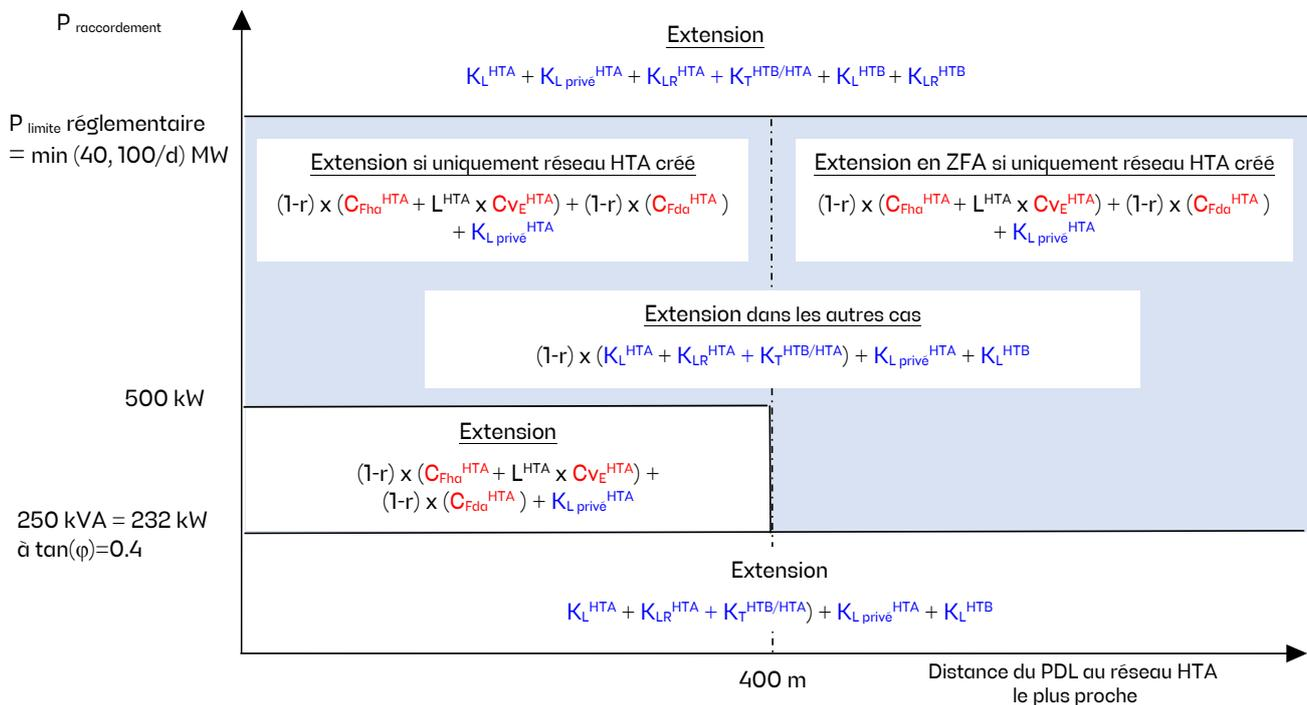
**Figure 3 : composants de la facturation des extensions HTA**
